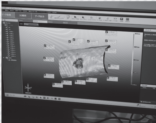
穴の開いた配管断面を分析。摩耗した部分が一目瞭然。
